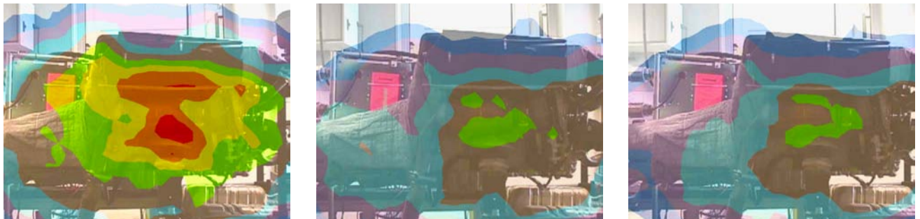
Motornahe Schallabsorption mit positiven thermischen Auswirkungen. (Abb. ohne, mit 5 mm, mit 10 mm Dämmdicke)
